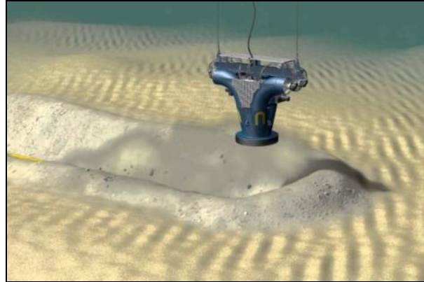
Figure 28 : illustration d'un Mass Flow Excavator
