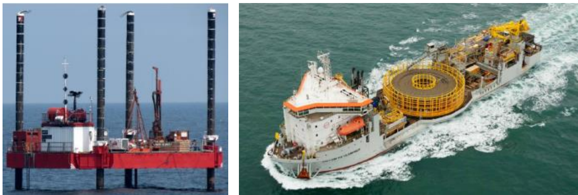
Moyens nautiques potentiellement à mettre en œuvre pour la partie marine du forage dirigé : (à gauche) exemple d'une barge jackup* et (à droite) d'un navire câblé
