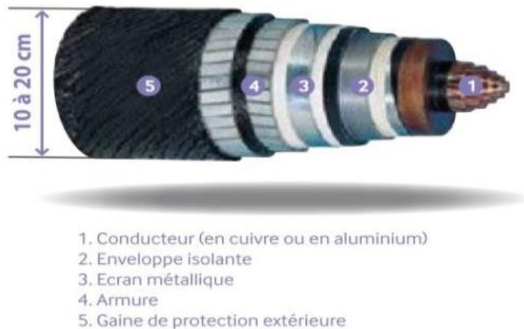
Figure 16 : Exemple d'un câble unipolaire à isolation papier imprégné (x2 pour une liaison à courant continu) – Source : RTE
