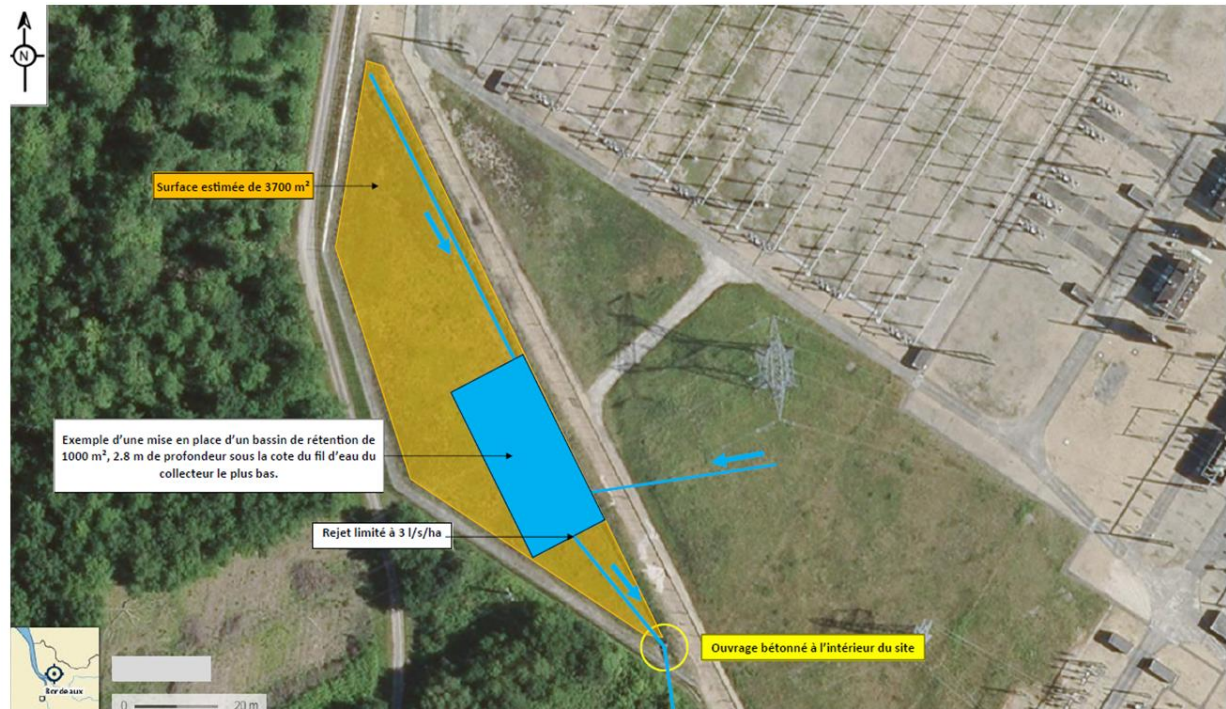
Figure 11 : Localisation du bassin de décantation - rétention
